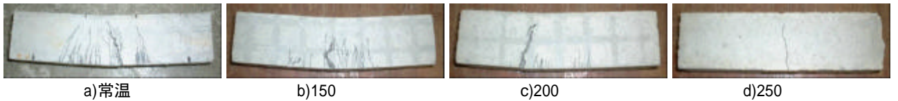
写真 1. 供試体の破壊状況
