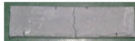
(c) ひび割れ状況 図4 DFRCC (4回目)
