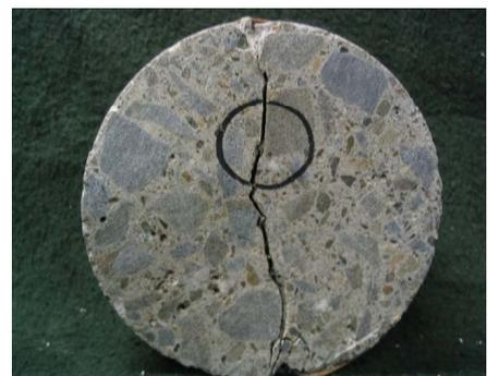
写真-6 破壊後の供試体
