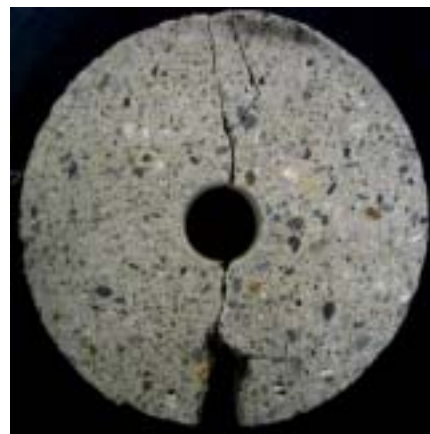
写真-3 破壊後の供試体 (中央:空洞)
