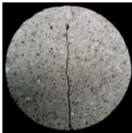
写真-1 破壊後の供試体(モルタル)
