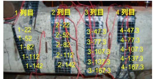
写真-2 ひずみゲージ貼り付け位置(S-3)
