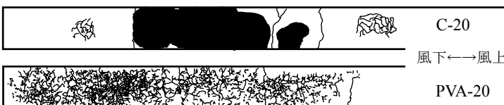
図-6 加熱によるひび割れ
