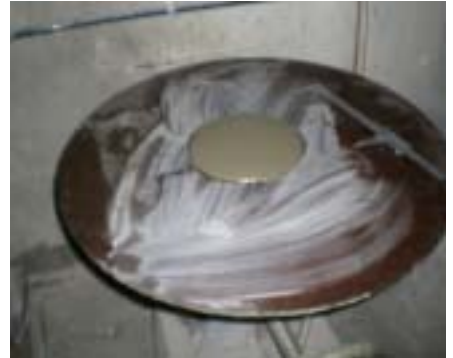
写真2 テーブルフロー試験状況
