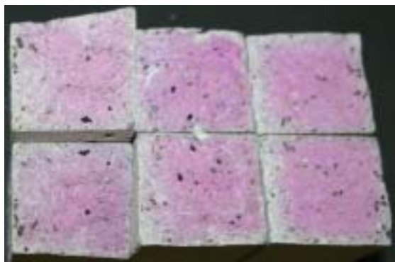
写真2 中性化深さ測定試験後の供試体
