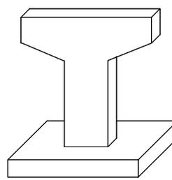
図4 RC矩形柱橋脚
