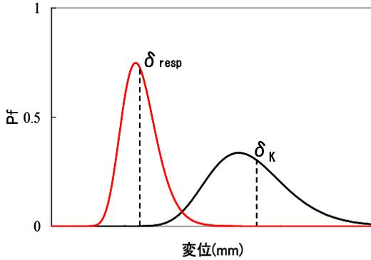
図2 損傷限界変位と応答変位の確率密度関数
