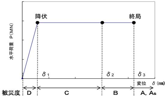
図6 荷重変位曲線と被災度
