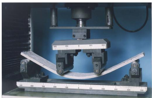
写真-1 DFRCC の曲げ試験<sup>1)</sup>
