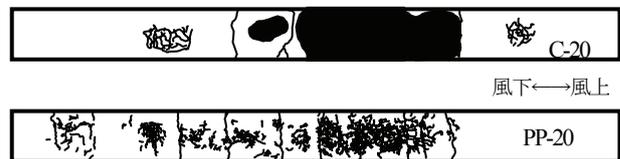
図-19 加熱によるひび割れ
