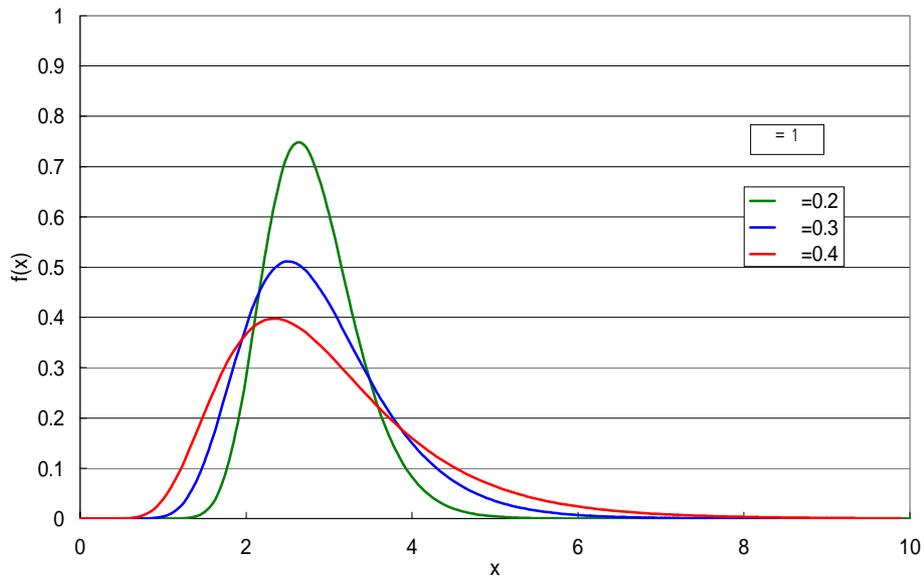
図5  $\sigma$  を 0.4 とし  $\mu$  をパラメータとした対数正規分布の確率密度関数
