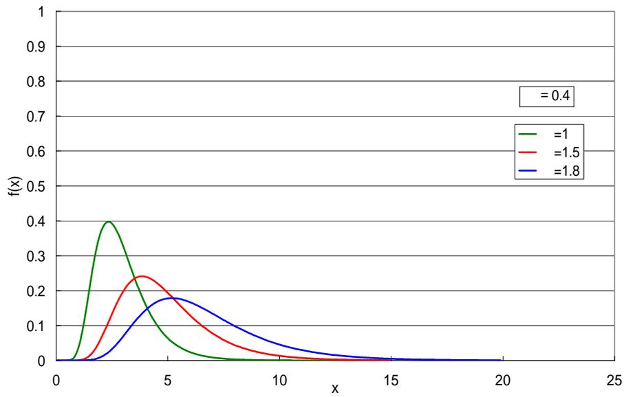
図7  $\mu$  を 1 とし  $\sigma$  をパラメータとした対数正規分布の確率密度関数
