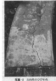
写真-2 方向性のひびわれ
