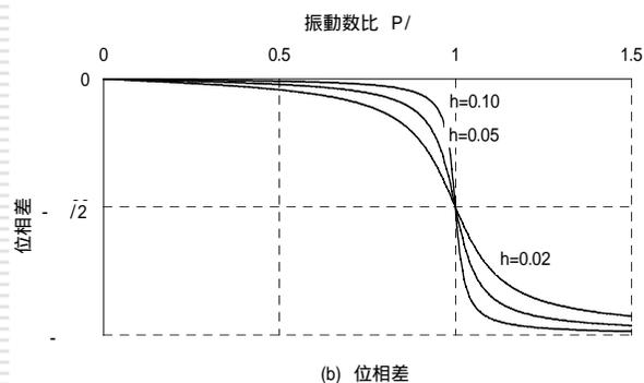
図3.4 調和外力に対する定常振動の動的応答倍率と位相差
