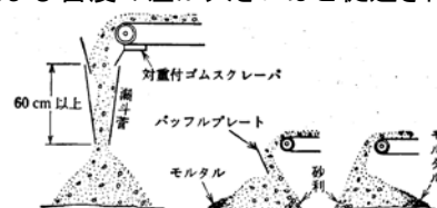
図7.3 ベルトコンベヤー使用上の注意(末端における分離の防止)
