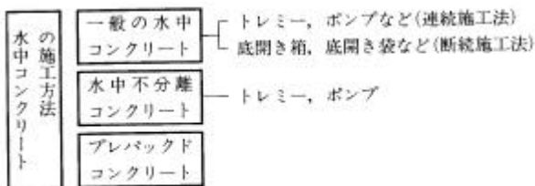
図 4-98 水中コンクリートの施工方法
