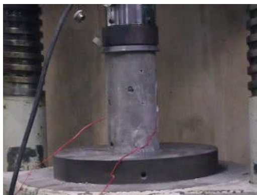
高強度コンクリートの圧縮破壊 特徴 強度は高いが、より脆性的な破壊をする。
