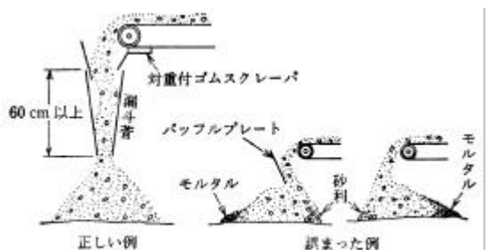
図7.3 ベルトコンベヤー使用上の注意(末端における分離の防止)
