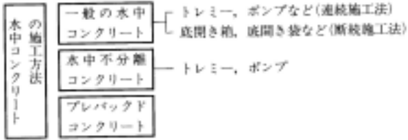
図4-98 水中コンクリートの施工方法
