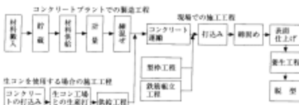
図7.2 コンクリートの製造・施工工程図
