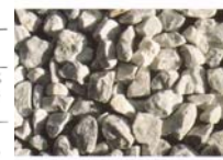
写真 08 セメントの主原料「石灰石」
