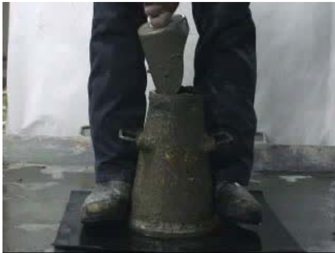
図6.7 スランブフローの測定器具の使用例
