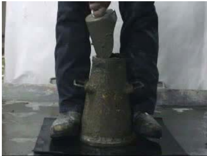
図6.7 スランプフローの測定器具の使用例
