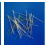
スチールコード :405.0 μm Lf:32.0mm
