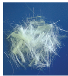
ポリエチレン φ: 12.0 μm Lf: 10.0mm ~15.0mm
