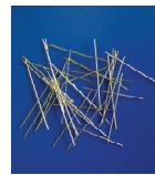
スチールコード φ: 405.0 μm Lf: 32.0mm
