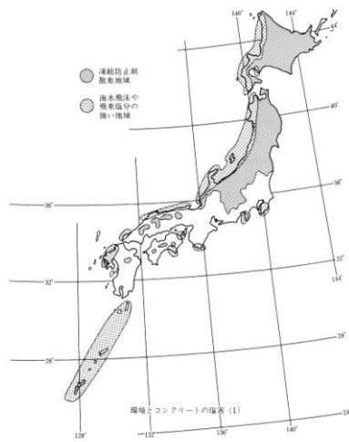
図 3.6 塩害とコンクリートの劣化[1]
